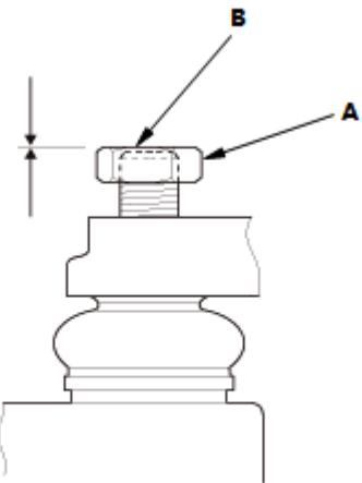
注意：确保螺母与球节销端齐平，以防止损坏球节销螺纹端。
